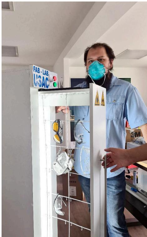
**Esterilizadores con luz UV, 253.7, nanómetros que entra en el rango de luz UVC germicida; con esto desnatura el ADN. A modo de presentación se utilizaron los tubos neón normales, no se utilizaron de UVC, por seguridad para su presentación de prueba, ya que la luz UVC no debe verse fijamente porque puede generar daños oculares.**
